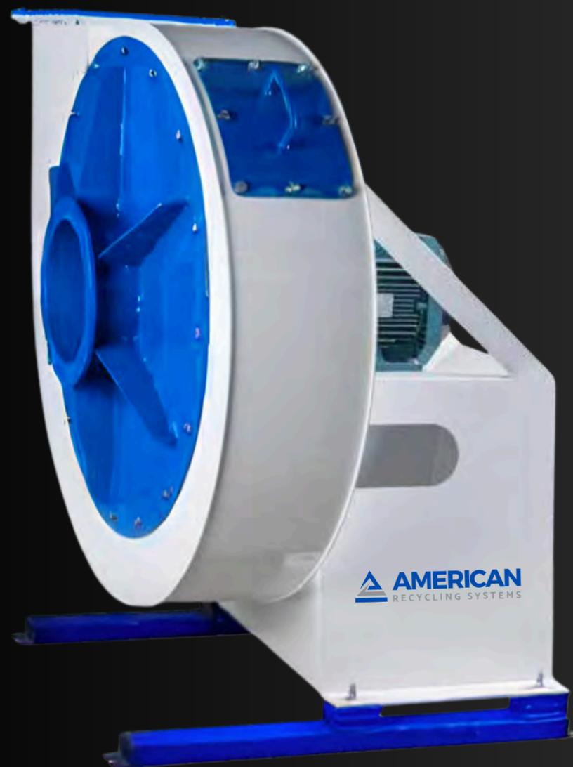
O ventilador de baixa pressão fornece aspiração para purificadores de sêmola e máquinas de limpeza, bem como aspiração geral para prevenção de poeira. Eles são fabricados em relação à pressão e vazão exigidas de as máquinas que estão sendo aspiradas. Amortecedores de vibração de borracha sob a máquina e isoladores de vibração de borracha na entrada e saída dos ventiladores isolam o edifício e os conectores da vibração.
