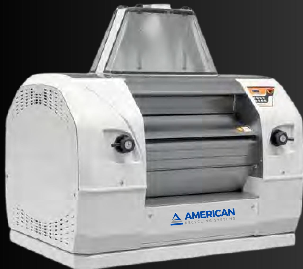
O moinho de rolos foi projetado para triturar e moer materiais sólidos por meio do uso de rolos rotativos. É especialmente eficaz para a moagem de grãos em processos de fabricação de alimentos e na indústria mineral para a redução do tamanho de partículas.
