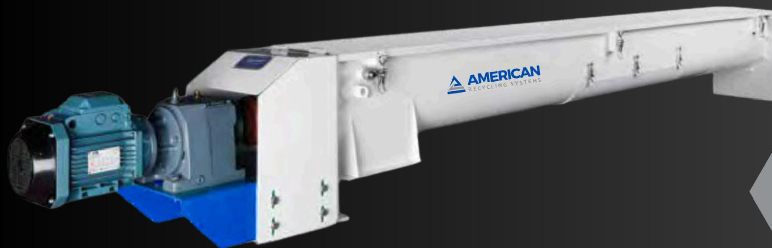
O transportador helicoidal é usado para o transporte horizontal de materiais granulares e em pó. É acionado por um motorreductor conectado diretamente. Em caso de atolamento, o mecanismo de controle de atolamento é ativado e o operador é informado.
