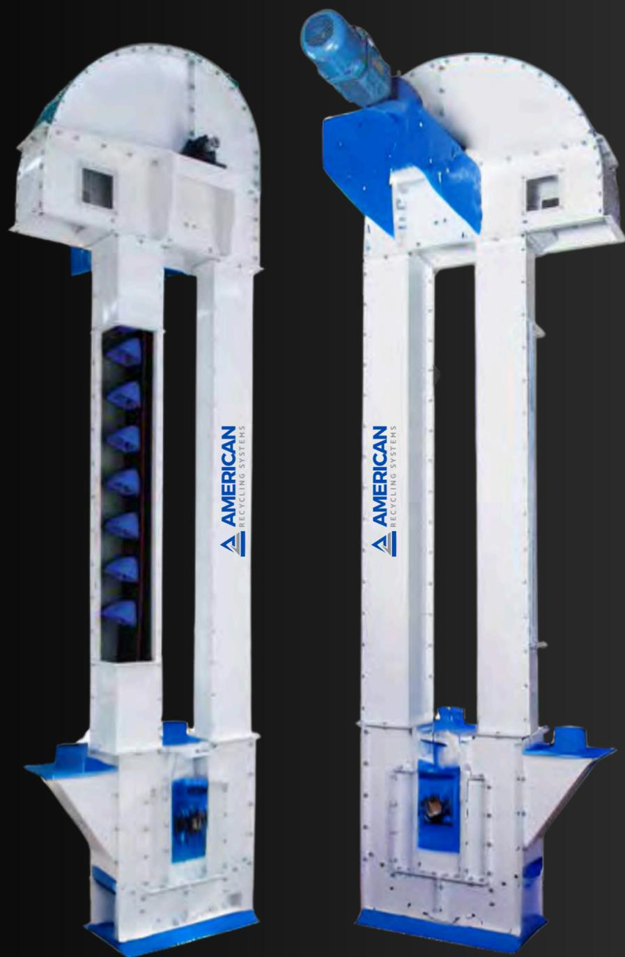
O elevador de canecas é utilizado para o transporte vertical de grãos e materiais em pó. Este transporte é realizado por meio de uma correia com canecas. O elevador de canecas consiste na parte superior, na parte inferior e nos tubos do elevador.
