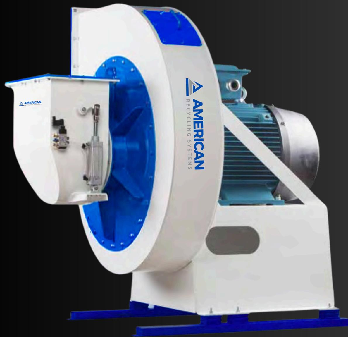
É utilizado para transporte horizontal e vertical de produtos por negativa pressão do ar. Produzido especificamente para cada linha pneumática; nossos ventiladores pneumáticos são projetados de acordo com as necessidades calculadas pressão do ar e fluxo de ar. Graças aos amortecedores de vibração de borracha embaixo da máquina e aos conectores de borracha na entrada e saída, a vibração é impedida de atingir a linha pneumática e o prédio..
