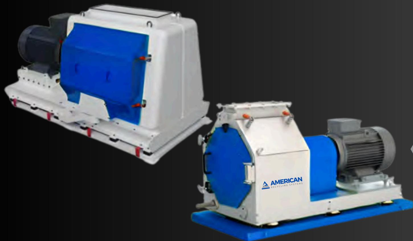
O moinho de martelo é usado para a moagem de materiais orgânicos estranhos descarregados na seção de limpeza. Consiste em brocas endurecidas girando em um tambor perfurado. Um ímã deve ser instalado na entrada. A construção é fácil de desmontar e permite fácil manutenção e limpeza. .
