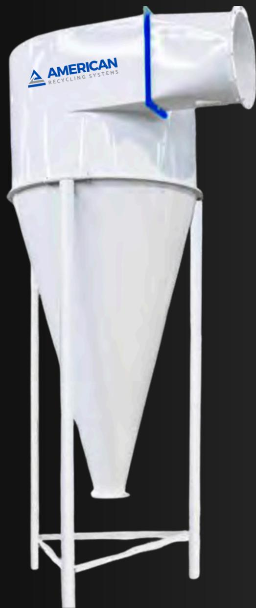
O ciclone é utilizado para remover o pó do sistema de aspiração. O ar que entra, poluído com poeira, move-se dentro do corpo por meio de forças centrífugas e por meio desse processo as partículas de poeira são removidas. Essa poeira vai para o ar trava colocada sob o ciclone de poeira.
